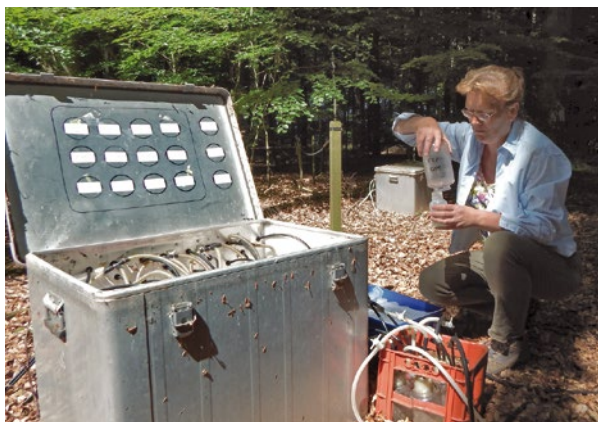
Probenahme Bodenwasser, Intensiv-Monitoringfläche Bornhöved Foto: O. Schwerdtfeger
