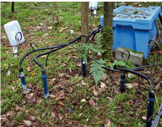
Tensiometer zur Messung der Bodenfeuchte
